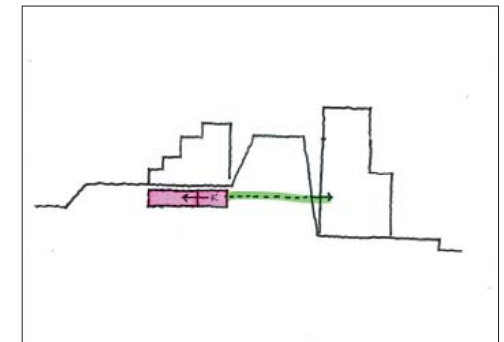
Prinsippsnitt. Parkeringskjeller på vestsiden av Rv36 kan også betjene østsida med P-plasser dersom man utbedrer eksisterende gangkulverter.
