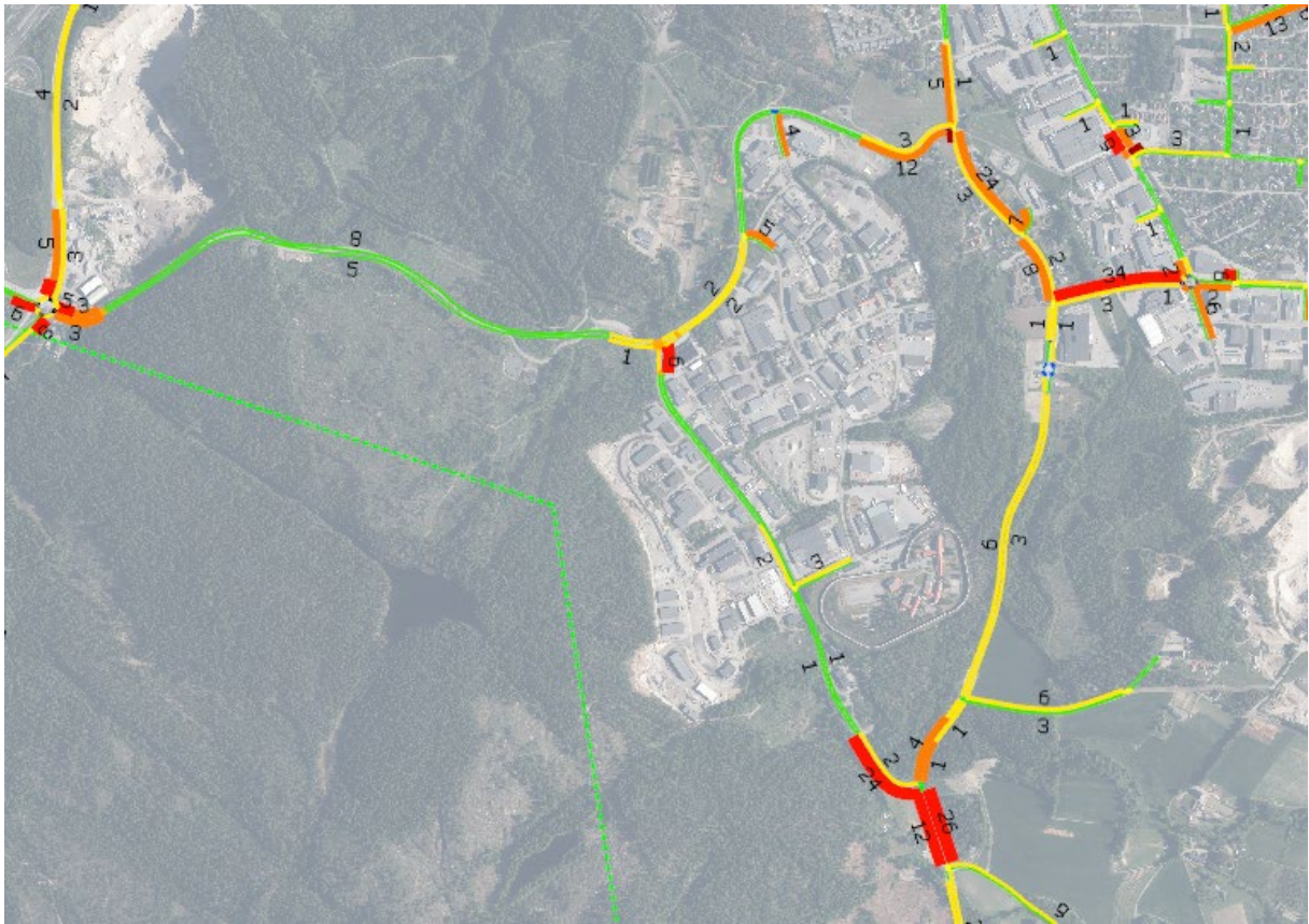
Figur 5 Maksimal forsinkelse i tidsperioden 1500-1700 med T-kryss. Tall i sekunder
